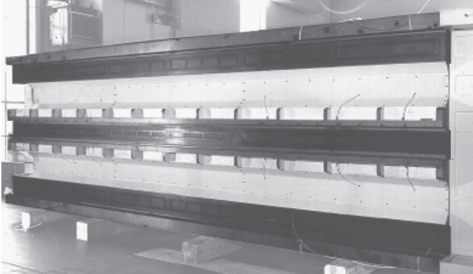
Bild 8: Werkzeugschlitten einer Portalfräsmaschine, hydrostatische Führung, Führungsmaße 6000 x 230, hydrostatische Taschen direkt abgeformt
